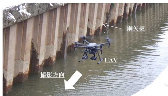
Fig. 2 UAV による画像計測 Set up for image acquisition by using UAV.
